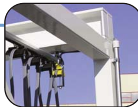
DETALLE CARRETILLA CABLES
