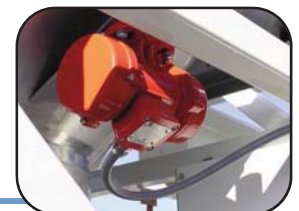
DETALLE MOTO VIBRADOR
